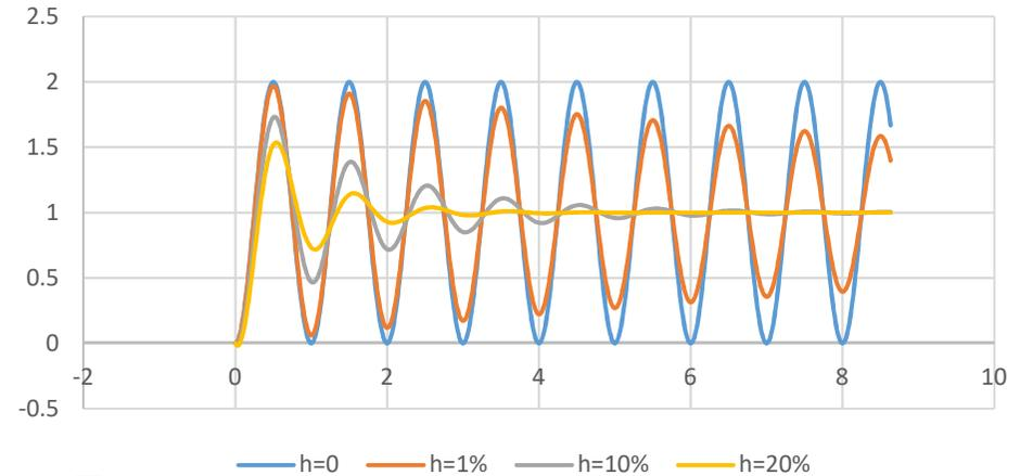
$$x(t) = \exp(-h\omega_o t) (A_1 \exp(i\omega_D t) + A_2 \exp(-i\omega_D t)) + \frac{F_e}{k}$$
