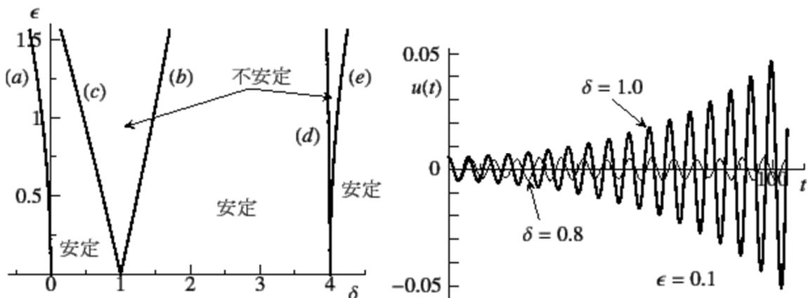
ブランコをこいだり, 斜張橋の桁加振に伴うケーブルの振動に相当. 係数励振と呼ばれる
